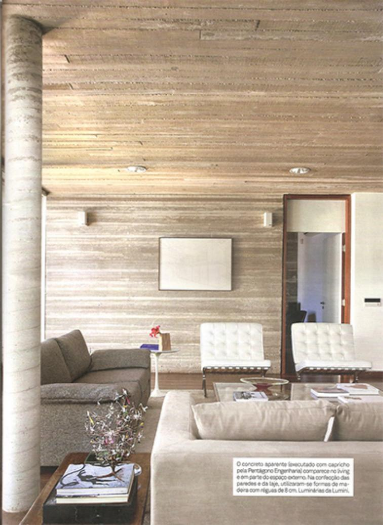
O concreto aparente (executado com capricho pela Pentágono Engenharia) compõe o living e em parte do espaço externo. Há contraponto das paredes e da laje, utilizando-se formas de madeira com vigas de 8 cm. Luminárias da Lumini.
